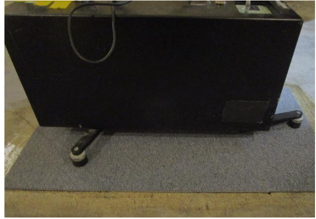
Vue d'un échantillon avec la machine à choc (Essai 2) View of a sample with the tapping machine (test 2)
